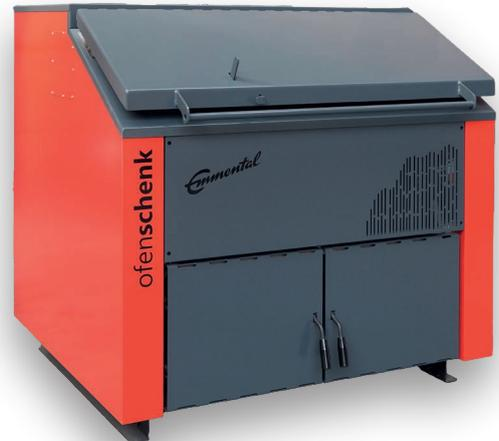
Im Schenk-Holzfeuerungskessel vergast das Holz in der Hochtemperatur-Brennkammer. Durch die intensive Verbrennung entsteht im Flammkanal eine Temperatur von bis zu 1000°C. Das Feuer brennt durch den Flammkanal am unteren Ende des Füllschachtes in die Brennkammer. Die Sekundärluft wird erhitzt und direkt im Flammkanal beigemischt.
