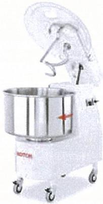
Eine interessante Variante sind die Spiralknetter mit aufklappbarem Kopf, welche eine vereinfachte Reinigung ermöglichen. Bei diesen Typen sind Kessel und Werkzeuge abnehmbar. Ein Flachrührer, der anstelle des Spiralknetters verwendet werden kann, ist bei allen aufklappbaren Maschinen im Lieferumfang enthalten. Es können mehrere Kessel eingesetzt werden.
